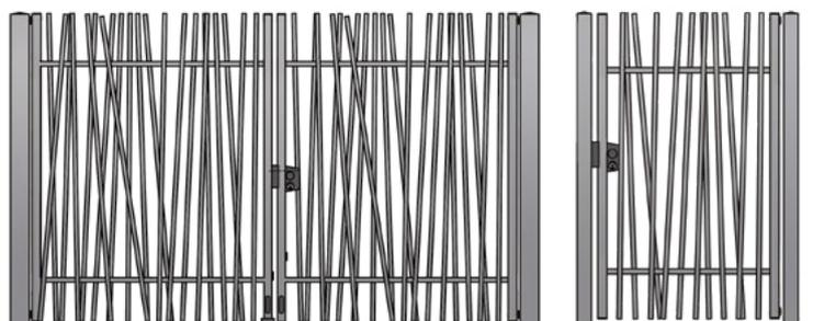
\* normaclo™ déconseille l'installation de produits avec barreaux dépassants la lisse haute lorsque la hauteur est inférieure à 1,50 m.
